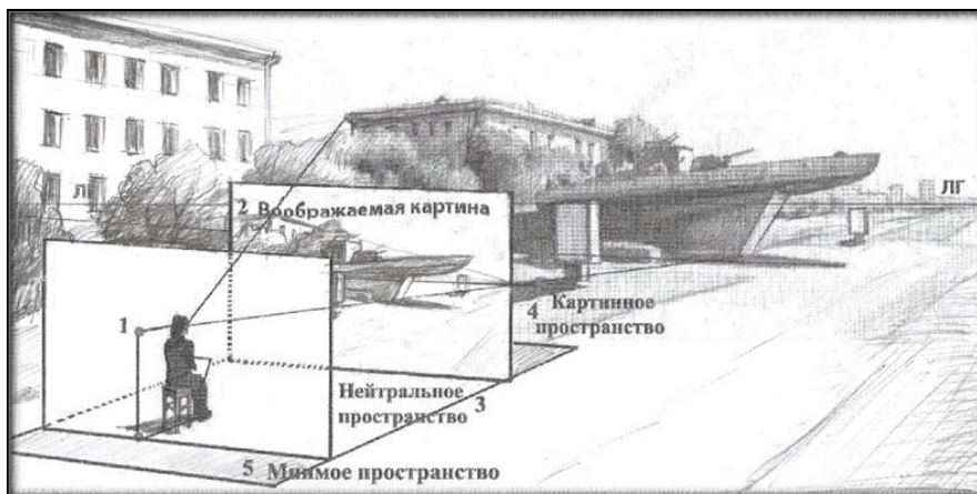
Рис. 4. Схема проецирующего аппарата центрального проецирования натуры
