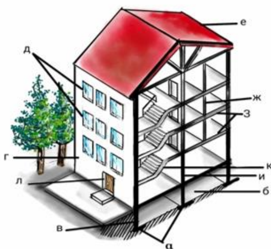
Рис. 1. Конструктивные элементы здания
